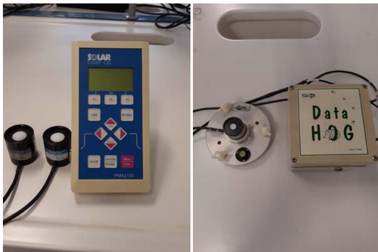
Σχήμα 4.5: Ραδιόμετρο και πυρανόμετρο μέτρησης της φωτεινής ακτινοβολίας σε εσωτερικούς και εξωτερικούς χώρους.
