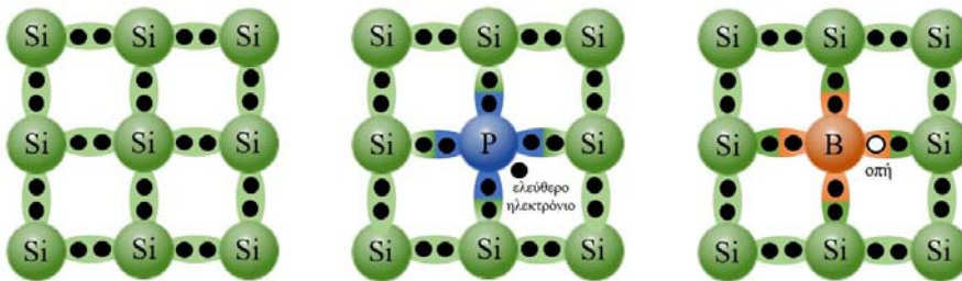
Σχήμα 1.5: Μετατροπή του ενδογενούς Si σε n- ή p-τύπου ημιαγωγό.
